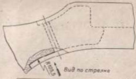
Рис. 81. Разделка паза для вкладки
