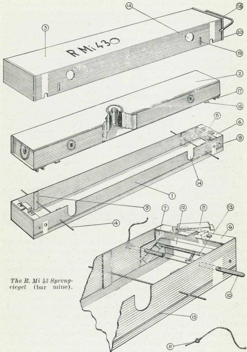
The R. Mi 43 Sprengriegel (bar mine).
