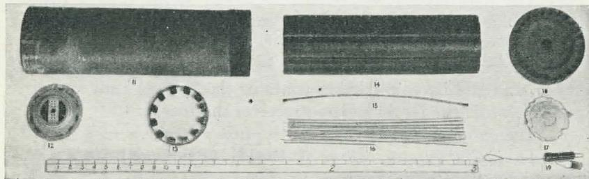
FIGURE 2. b. COMPONENTS OF ROCKET MOTOR.
