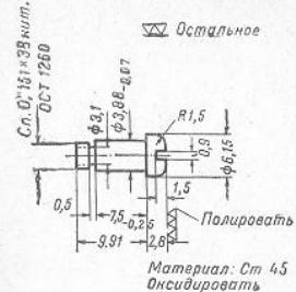
Рис. 81. Винт дверцы
