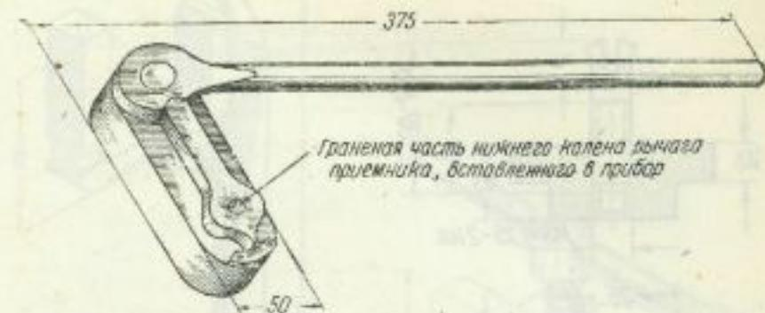
Рис. 8. Приспособление для скручивания нижнего колена рычага приемника Д-ПП ПМ-14.
