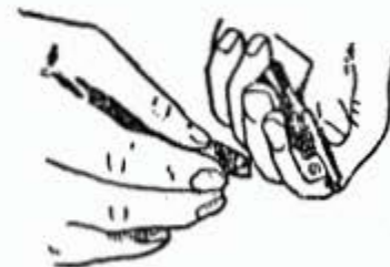
Rys. 49. Odłączanie sworznia przelącznika od obsady przerywacza
