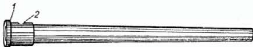
Rys. 5. Lufa: 1 — kolnierz, 2 — wycięcie
