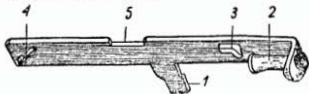
Rys. 63. Bezpiecznik: 1 — rączka bezpiecznika, 2 — tulejka oporowa, 3 — wycięcie trójkątne do główki osi spustu, 4 — wycięcie łukowe do wodzika bezpiecznika, 5 — wycięcie do rączki zamkowej
