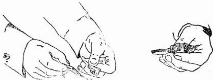
Rys. 50. Wkładanie przerywacza do obsady
