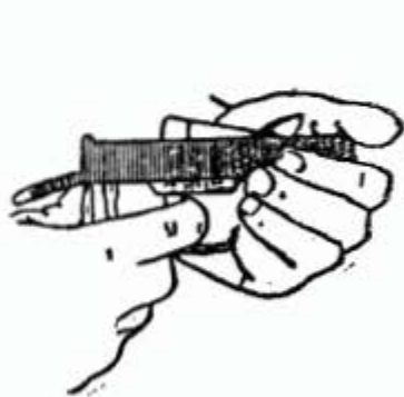
Rys. 45. Przesunięcie przelącznika na ogień pojedynczy
