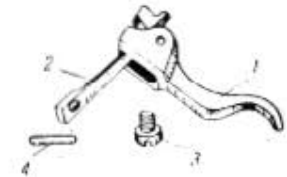
Rys. 148. Urządzenie spustowe: 1 — spust; 2 — zaczep kurkowy; 3 — wkręt zaczepu kurkowego; 4 — oś
