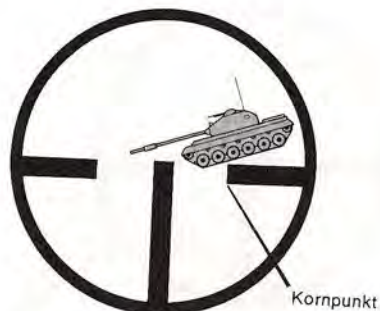
Bild 1: 10. Riktning mot mål med sidfart i sidlutande terräng, sidfart 15 km/h
